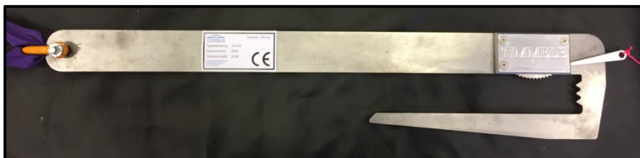
Bild 2. Lyftredskap med beteckning JCA 02, längd: 680 mm
